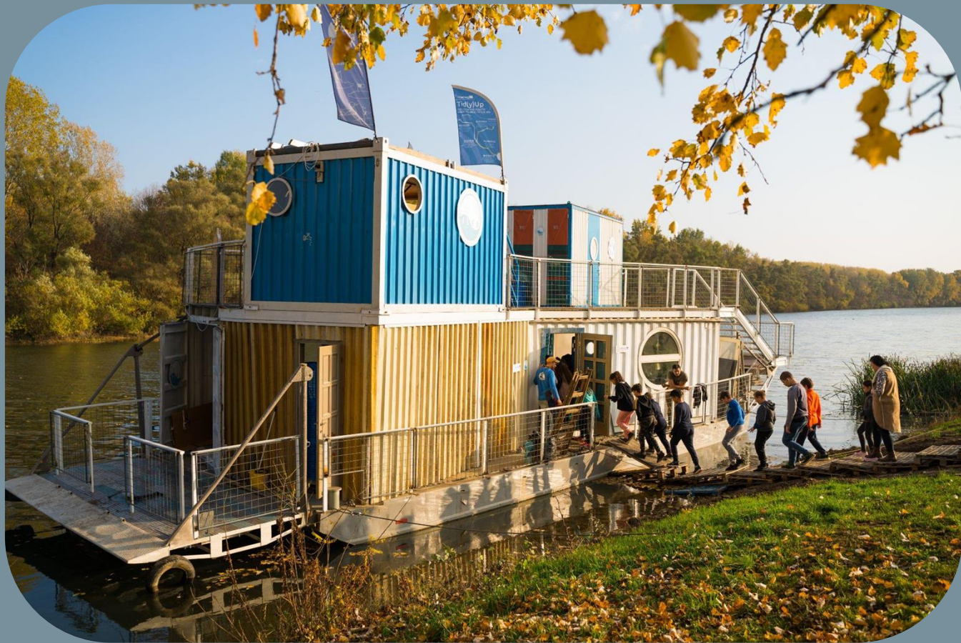
Найбільший у світі корабель ПЕТ-піратів – FLEX-Sárazsadány. FLEX розшифровується як Floating Exhibition, тобто Плавуча виставка. Корабель більш ніж на 90% складається з відходів, під час його будівництва використано кілька тонн переробленого пластику. На цьому кораблі навчається нове покоління рятувальників річок. Фото: Петер Варга.
